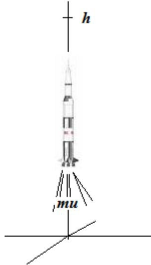
Solución: Teniendo en cuenta la segunda ley del movimiento de Newton, en el instante  $t$ , el cohete a una altura  $y=y(x)$  debería experimentar una aceleración neta de  $y'' = u - g$ . Además, hemos de imponer las condiciones  $y(0) = y'(0) = 0$ ;  $y(T) = h$
